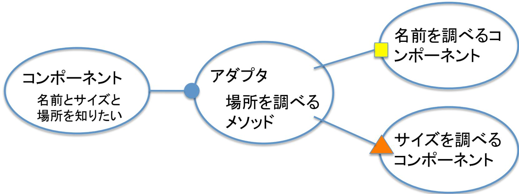
インタフェースの違いを吸収しながら、各種コンポーネントの機能を組み合わせて提供する
